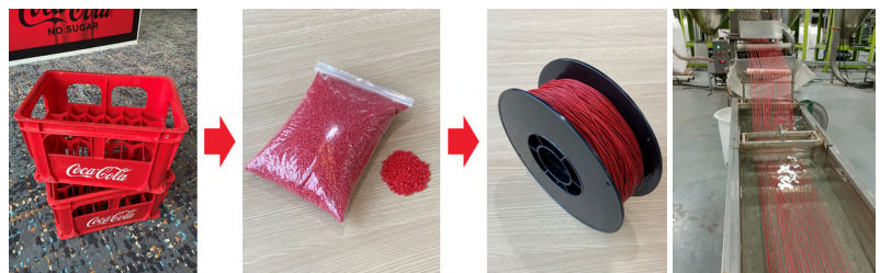
可回收玻璃瓶箱的造粒流程
